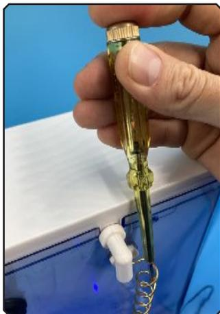
Munissez-vous du tournevis testeur. Enlevez le capot de la fontaine et touchez l'électrode avec la pointe du tournevis. En même temps, posez l'un de vos doigts sur le dessus du tournevis comme indiqué sur la photo de gauche. Vous devez observer une petite lumière sur le tournevis. Si la lumière s'allume, c'est que la dynamisation fonctionne.
